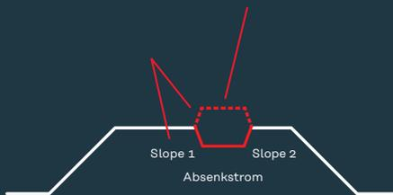
Je nach eingestelltem Absenkstrom kann ein Up- oder Down-Slope verwendet werden.
