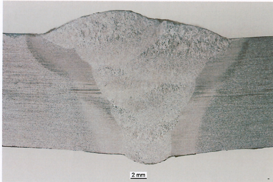
56-10 Makroaufnahme der Schweissung macrograph of weld macrographie de la soudure
