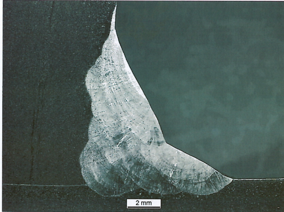
08-1 Makroaufnahme der Schweissung macrograph of weld macrographie de la soudure
