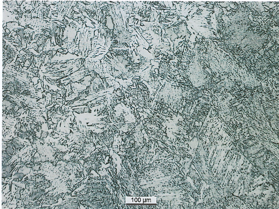
05-3 Mikroaufnahme der Schmelzlinie micrograph of fusion line micrographie de la soudure
